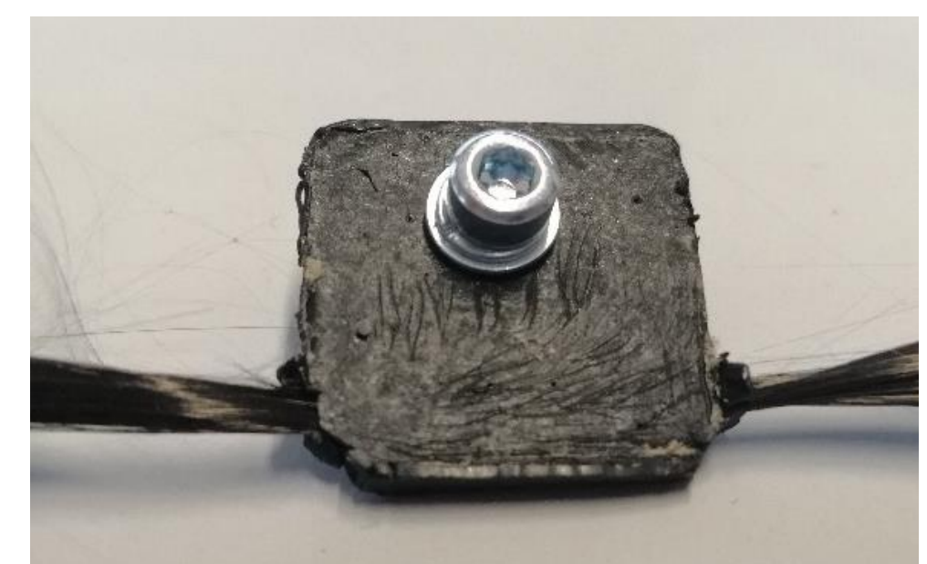
Abb. 4: Prototyp Kontaktierung Carbonfaser [Quelle: HTWK Leipzig]
