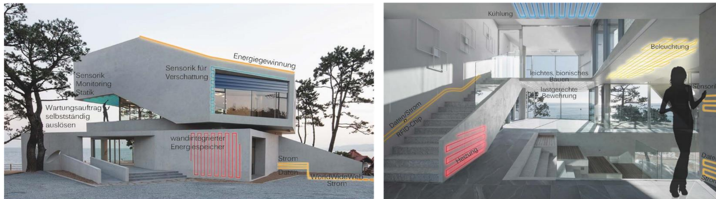
Abb. 2: Funktionalisierter Carbonbetonbau der Zukunft (Außenfunktionen, Innenfunktionen)
